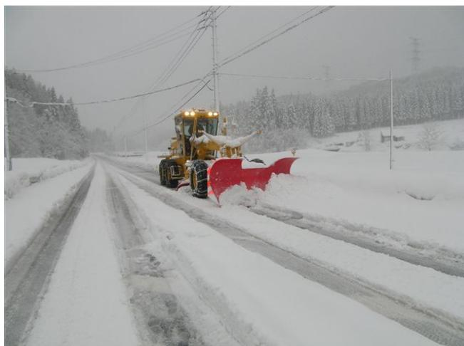
写真 除雪グレーダのアングリングプラウによる除雪作業
