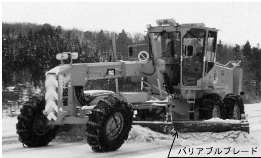
写真 バリアブルブレードを使用して除雪中の除雪グレーダ
