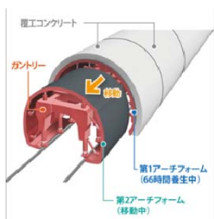
新型テレスコピックセントル施工概念図
