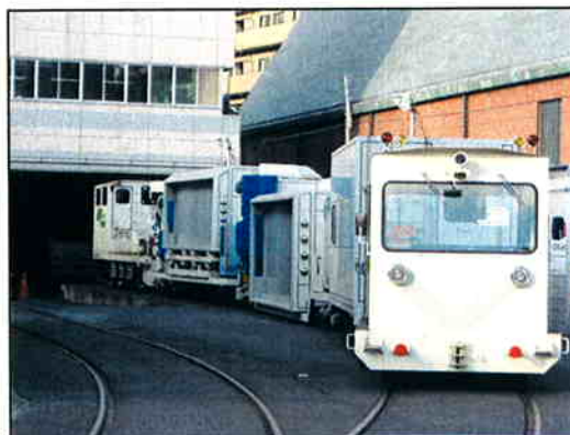
写真-2 トンネル部石綿除去作業専用台車
