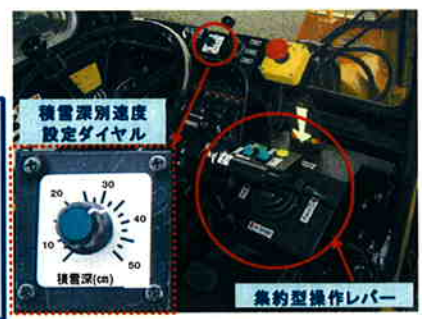
写真-1 簡易操作型歩道除雪車の運転室
