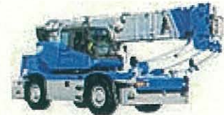
ホイールクレーン (ラフテレーンクレーン)
