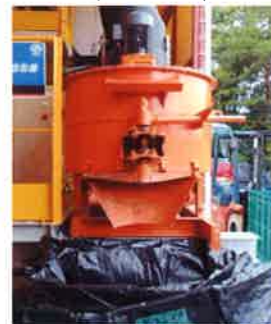
(d) 濃縮残渣(脱水ケーキ)造粒装置
