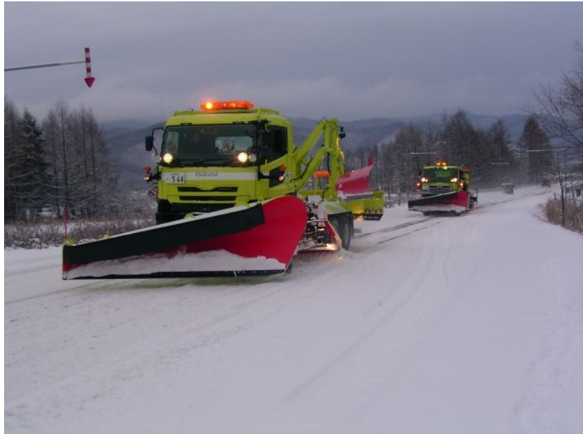
写真 シャッターブレードによる除雪作業(除雪機械全景) (タイプ4)
