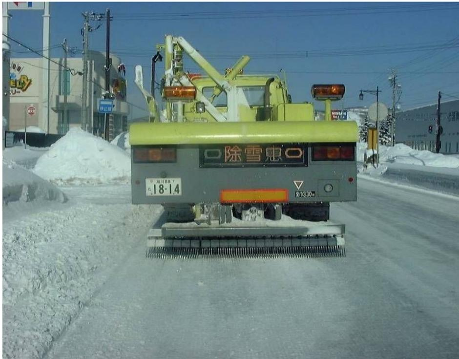
写真 粗面形成装置(除雪トラック用)による作業
