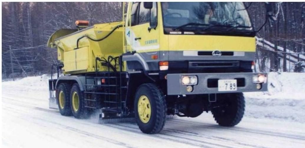
写真 粗面形成装置(凍結防止剤散布車用)による作業
