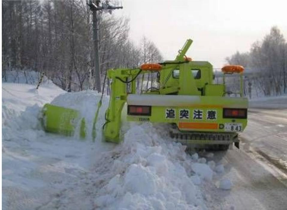
写真 マックレー装置による除雪作業
