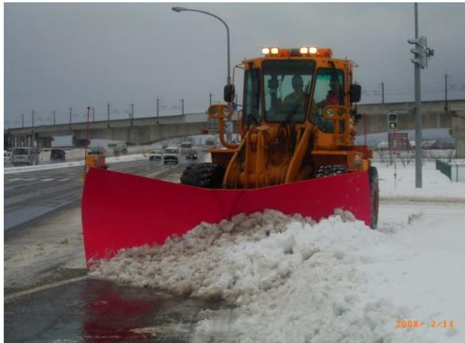
写真 マルチプラウ(雪を抱え込んで作業中。アングリングプラウ形状)
