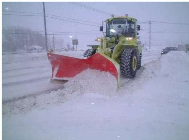
写真 マルチプラウによる道路除雪作業中(Uプラウ形状)
