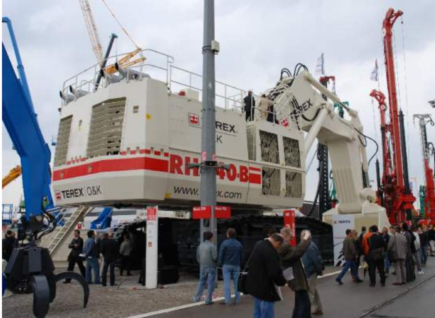
TEREX社は超大型油圧ショベルのRH340-B(運転質量550トン、バケット容量34立方メートル)は、バウマンナンバーワンの巨大ショベル。運転席上部までの高さは8.8メートル。
