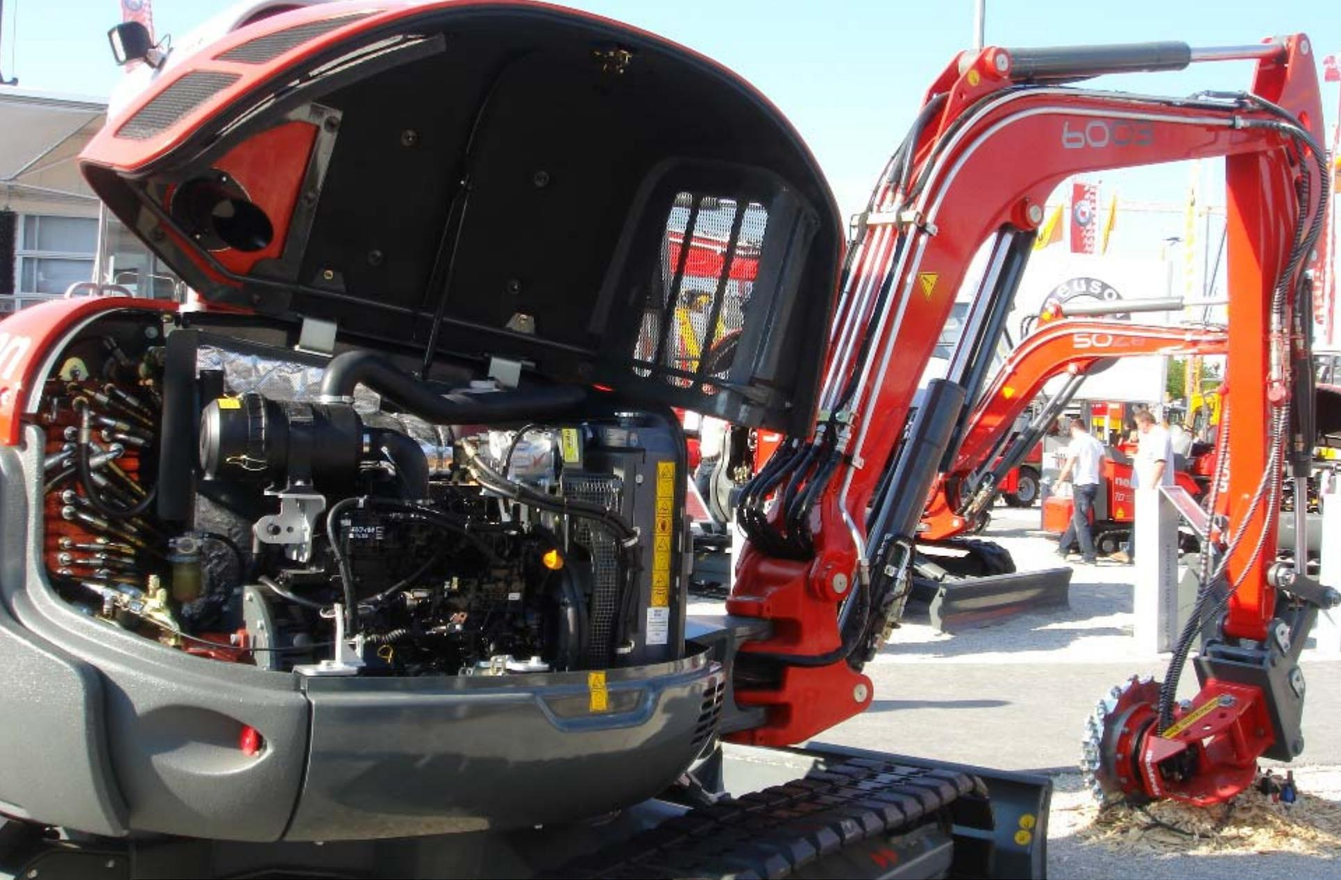
NEUSONの6t機。各社ボンネットが大きく開いて、メンテナンス性の良さをアピールしている展示が多い。
