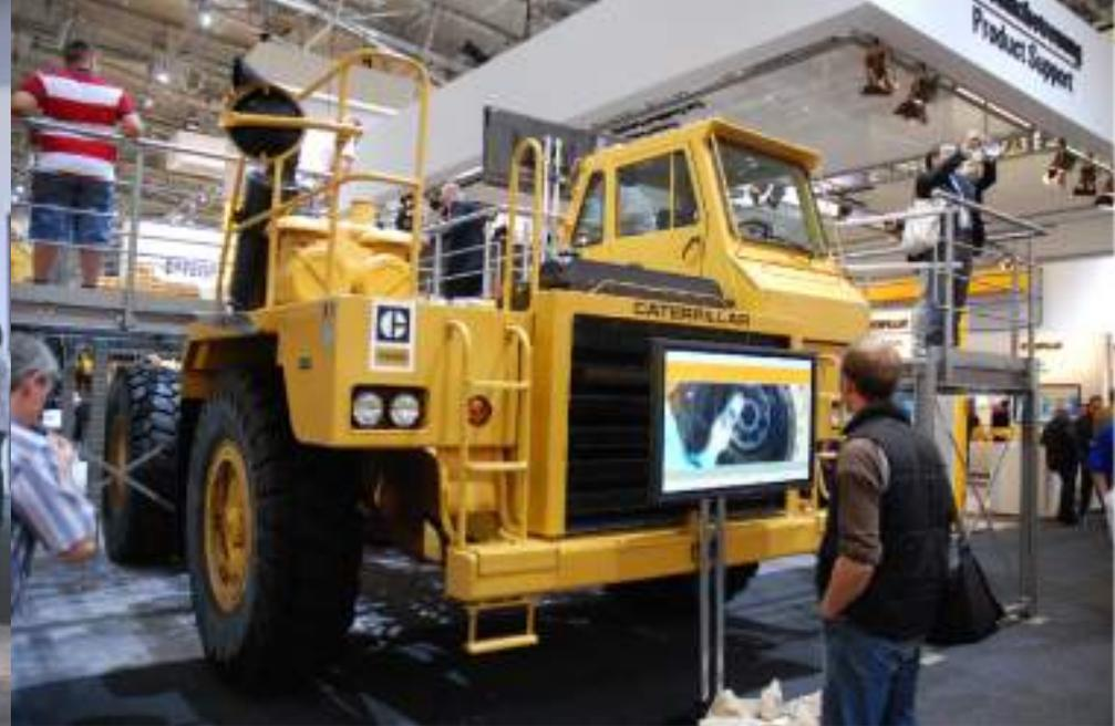
足回りのカットモデルや、プロダクトリンクシステムを説明するジオラマも展示していた。Certified Usedとして、保証つきの中古車として769Cダンプトラックと950G IIホイールローダの実物を展示。769Cは1984年に製造されたもので、稼働時間は16,216時間。本体フレームなどはそのままに、エンジンやパワートレインの一部を交換した様子を、車体上部からも確認することが可能。
