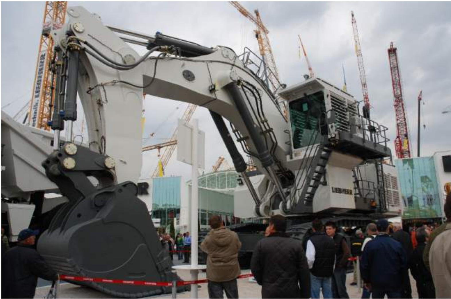
**LIEBHERR超大型ダンプトラックの横には、これまた超大型油圧ショベルR9250(運転質量250トン、バケット容量15立方メートル)。稼働現場に応じて油圧駆動と電力駆動の使い分けが可能。**
