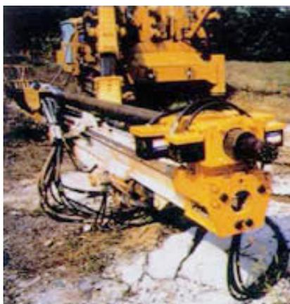
削岩機に鋼管を装着した状態
