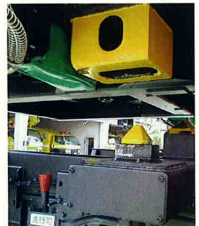
写真-1 ベースとユニットの締結構造
