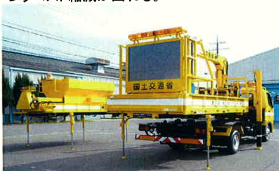
写真-2 作業標識ユニット搭載状況と凍結防止剤散布ユニット
