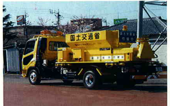
写真-3 凍結防止剤散布ユニット搭載状況
