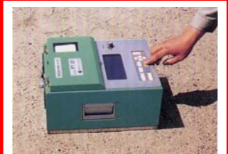
RI法による品質計測 (100m 2 毎に1点計測)
