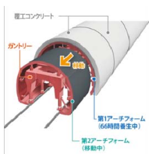
新型テレスコピックセントル施工概念図
